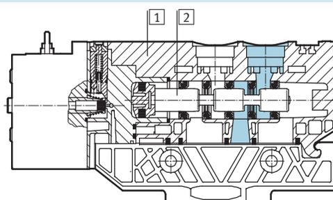
Esquema de funcionamiento: válvula biestable
