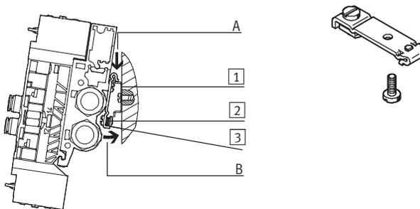
El terminal de válvulas VTUB se cuelga en el perfil DIN (ver flecha A). A continuación se presiona el terminal de válvulas VTUB y se fija mediante la pieza de bloqueo (ver flecha B).
