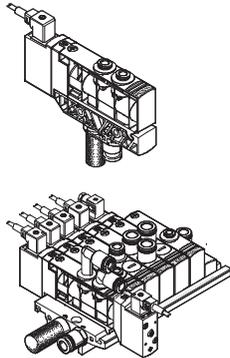
Conexión posible independientemente del control y con conexión flexible mediante cables preconfeccionados. Se ofrecen dos tipos de válvulas: válvulas con conexiones roscadas y válvulas con semiconexiones roscadas para perfiles distribuidores o para placas base. En caso de conexión individual, puede elegirse entre 2 ... 32 bobinas (repartidas entre 2 ... 16 posiciones de válvulas).
