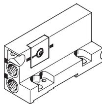
En las placas finales con selector, la salida de las conexiones está dirigida hacia la parte delantera del terminal de válvulas. De esta manera es posible unir todas las conexiones en el sentido de la descarga.
