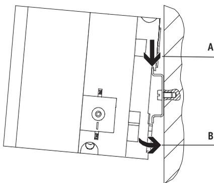
El terminal de válvulas MPA-F se cuelga en el perfil DIN (ver flecha A). A continuación se gira el terminal MPA-F y se fija con las piezas de bloqueo (ver flecha B).
