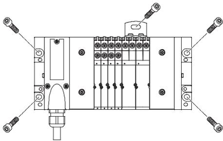
El terminal de válvulas MPA-F se fija a la superficie mediante cuatro tornillos M6. Los taladros de fijación se encuentran en la interface neumática
