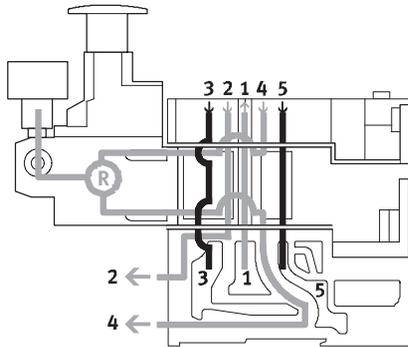
Este regulador de presión permite ajustar la presión en el canal 4 una vez que el fluido ha atravesado la válvula. Durante la operación de evacuación de aire, se produce el escape desde el canal 4 hacia el canal 5 a través del regulador de presión.
