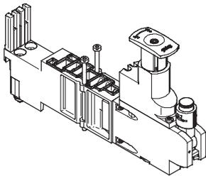
Para controlar la fuerza de los actuadores es posible montar un regulador entre la placa base y la válvula correspondiente.
