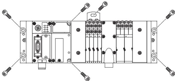
El terminal de válvulas MPA-F se fija a la superficie mediante seis tornillos M6. Los taladros de montaje se encuentran en la placa final del lado izquierdo (CPX) y en la placa final del lado derecho (MPA-F).
