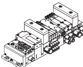
Los controles integrados en los terminales de válvulas de Festo permiten la creación de unidades de mando independientes (stand alone) con IP65 y sin armario de distribución.
