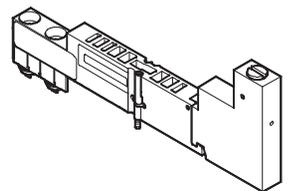
Utilizando la placa vertical de bloqueo de presión es posible sustituir la válvula individual mientras el equipo está en funcionamiento y sin tener que desconectar la alimentación central de aire comprimido.
