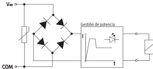
Cada bobina MPA tiene un circuito protector para supresión de arco voltaico y, además, tiene polaridad incondicional. Además, todas las válvulas están equipadas adicionalmente con una reducción integrada de la corriente.
