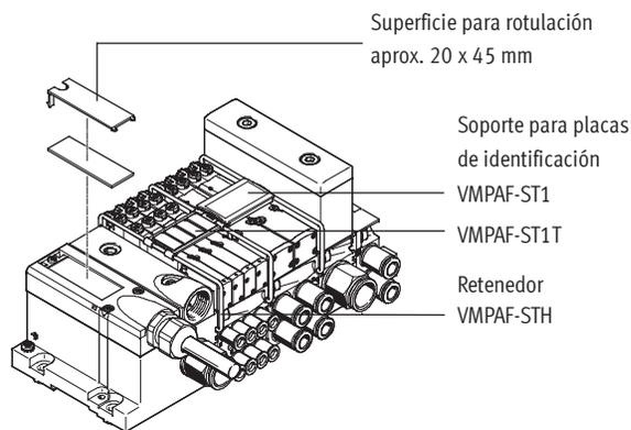
Para identificar las válvulas puede montarse en cada placa de alimentación un soporte de placas rotulables VMPAF-ST1 (nº de art. 546 228, código T en el código de pedido) o VMPAF-ST1T (nº de art. 544 422, código T en el código de pedido) con placas de identificación IBS-9x20). A modo de alternativa o adicionalmente pueden colocarse placas de
