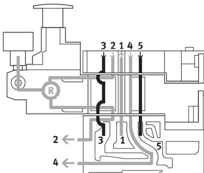
Este regulador de presión permite ajustar la presión en el canal 2 una vez que el fluido ha atravesado la válvula. Durante la operación de evacuación de aire, se produce el escape desde el canal 2 hacia el canal 3 a través del regulador de presión.
