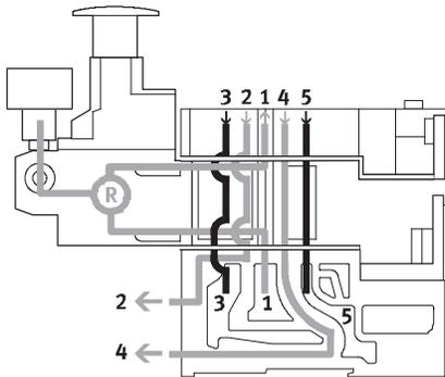
Este regulador regula la presión en el canal 1, delante de la válvula. De esta manera, los canales 2 y 4 tienen la misma presión regulada.
