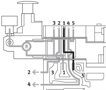
El regulador A reversible distribuye el aire de trabajo en el canal 1 y regula la presión delante de la válvula en el canal 5 (en el canal 3 se aplica la presión no regulada del canal 1). A continuación, el aire regulado se desvía hacia el canal 4. Ello significa que la válvula está funcionando en modalidad reversible.
