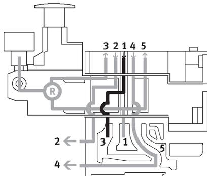
El regulador B reversible distribuye el aire de trabajo en el canal 1 y regula la presión delante de la válvula en el canal 3 (en el canal 5 se aplica la presión no regulada del canal 1). A continuación, el aire regulado se desvía hacia el canal 2. Ello significa que la válvula está funcionando en modalidad reversible.
