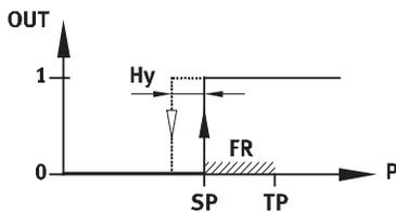
El punto de conmutación se obtiene mediante la presión memorizada y la reserva de funcionamiento. De la presión memorizada se deduce una reserva de funcionamiento (35 por ciento de la presión memorizada) ( $SP = TP - 0,35 \cdot TP$ ).
