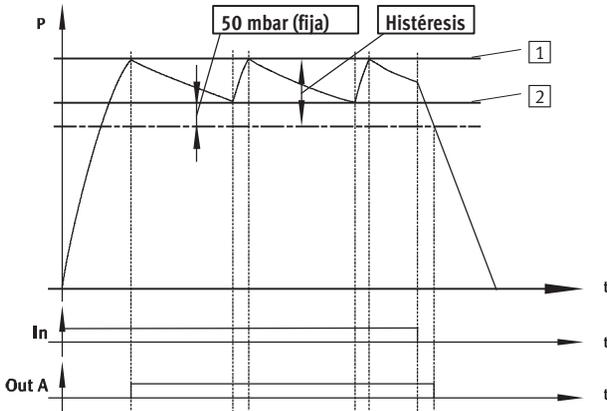
Una vez que se alcanza el valor umbral **1** del vacío, se desconecta automáticamente la generación de vacío. Una válvula antirretorno evita la caída del nivel de vacío. Sin embargo, debido a las fugas (ocasionadas, por ejemplo, por superficies rugosas de las piezas) se
