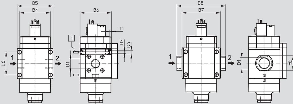
1 Tornillo M6xmin.90 según DIN 912 (no incluido en el suministro) para montaje en la pared sin escuadra de fijación
