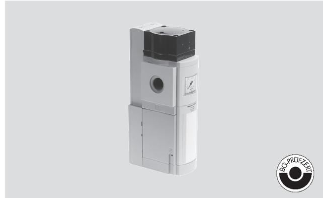
La válvula electroneumática de arranque progresivo y de escape sirve para generar presión de modo rápido y seguro y para reducir controladamente la presión en sistemas neumáticos y equipos industriales. Se trata de un sistema mecatrónico con autodiagnóstico y redundante,
